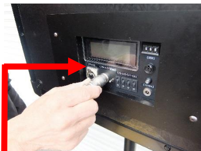
<リモコンケーブルの接続> マークを上にしてカチッと音がするまで差し込む
