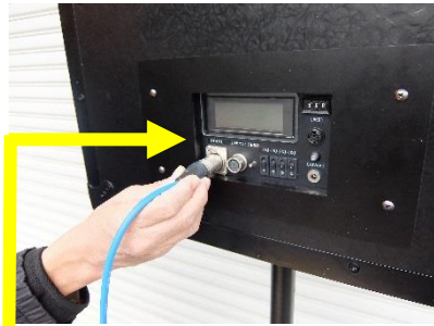
<計測マイクケーブルの接続> カチッと音がするまで差し込む
