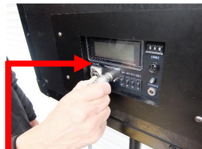
<リモコンケーブルを外す> 一番太い部分を持って手前に引っ張り抜く
