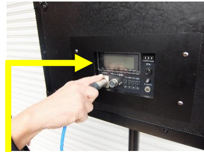
<計測マイクケーブルを外す> 金具ピン(ロックピン)を押しながらプラグを抜く
