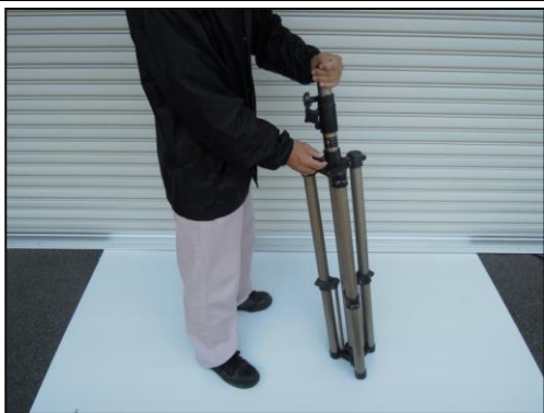
①右手部のネジをゆるめる
