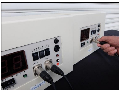
＜子機⇄子機間 通信ケーブルの接続＞
