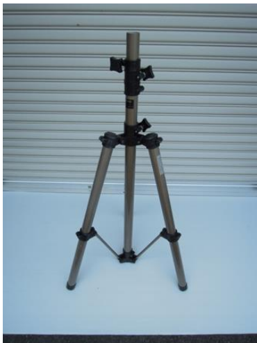
＜広げた脚が狭いため不安定な状態＞
