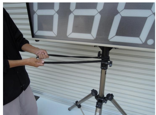
⑫ゴム紐等を利用して固定物へとめ転倒防止に務める
