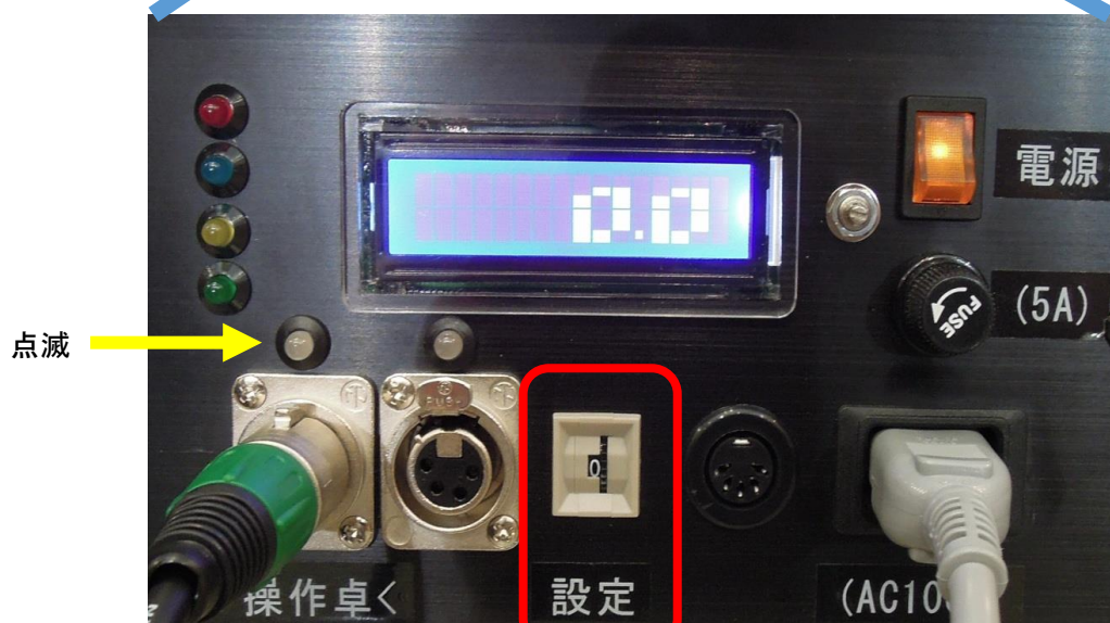
【表示機の接続パネル】
