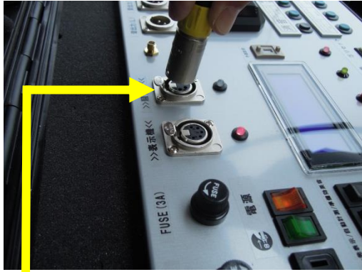
<通信ケーブルの接続> カチッと音がするまで差し込む
