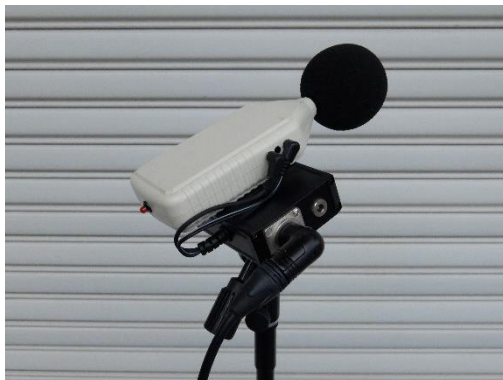
<騒音計ユニットへ4Pin 通信ケーブルを接続>
