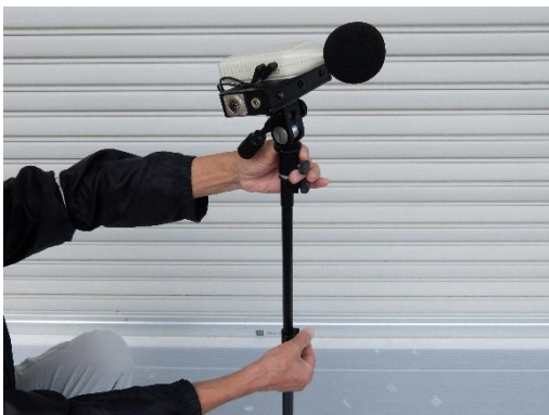
⑦右手:ネジをゆるめ騒音計ユニットの高さを調節
