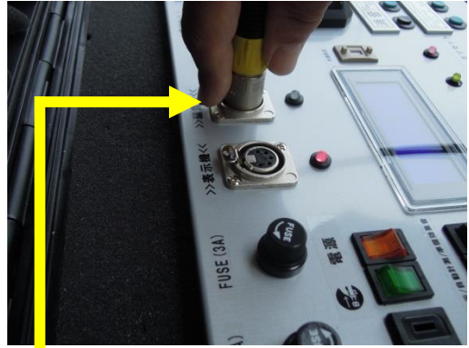
<通信ケーブルを外す> 金具ピンを押しながらプラグを抜く
