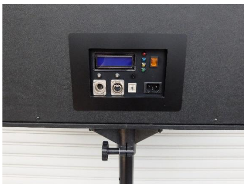
<表示機へ5Pin 通信ケーブルと電源を接続>
