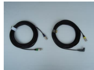
<通信ケーブル 左:表示機 右:騒音計ユニット>
