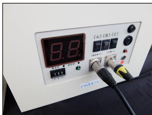
<子機 ターミネーターを接続>
