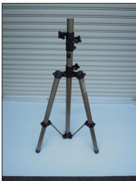
<広げた脚が狭いため不安定な状態>
