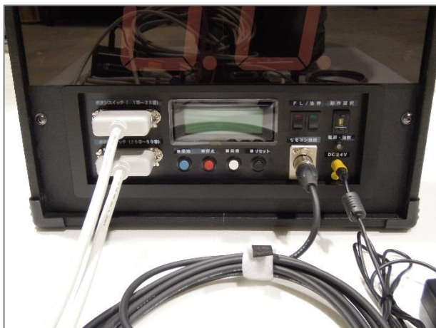
↑ 左側(白コード2本)⇔中継ボックスへ接続 リモコンスイッチと電源を接続する
