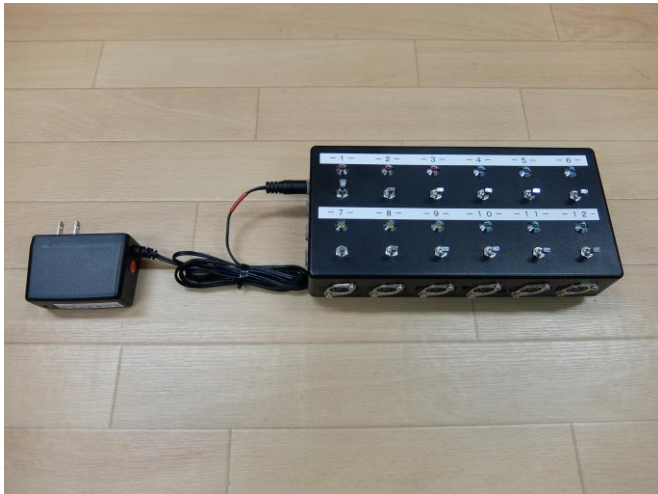
電源一系統で3台の回転灯を操作できます。
