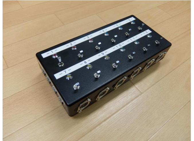
左側面に電源入力、4系統(赤・青・黄・緑) 前後に6個の回転灯へのコネクタ
