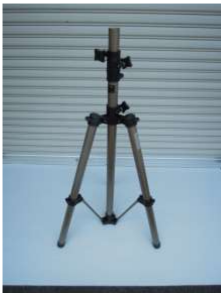
<広げた脚が狭いため不安定な状態>
