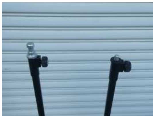
左：16mmダボ金具凸 右：5/8 ネジ
