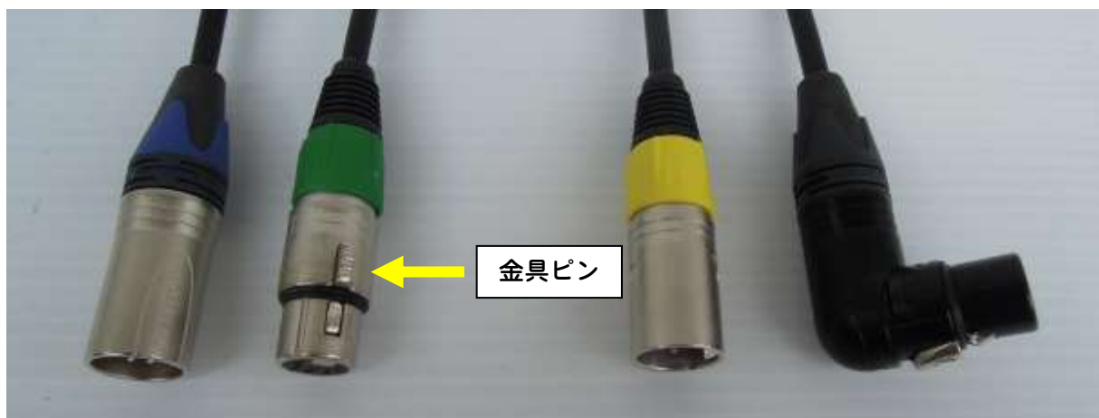
＜表示機通信 3Pin15m ケーブル＞
