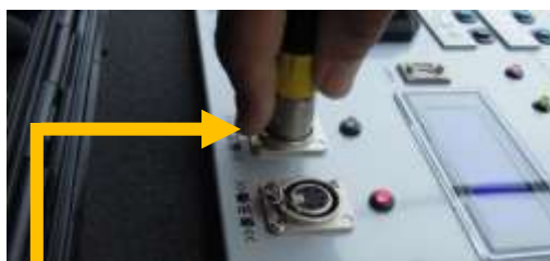
＜通信ケーブルを外す＞ 金具ピンを押しながらプラグを抜く
