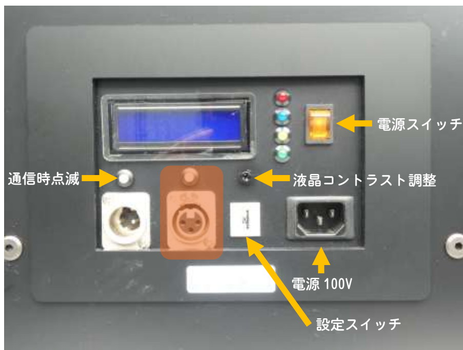
【表示機のウラ面 接続パネル】
