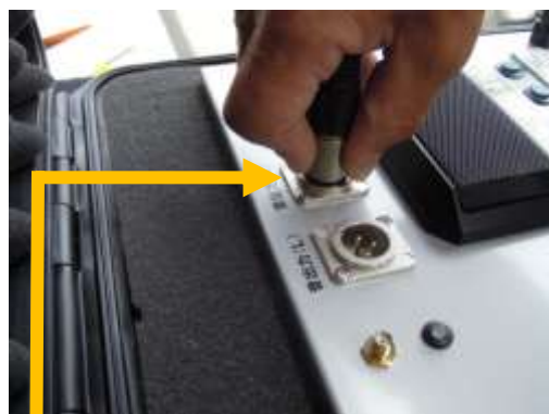
＜効果音出力ケーブルを外す＞ 金具ピンを押しながらプラグを抜く
