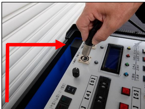
<操作卓 通信ケーブルの接続> カチッと音がするまで差し込む
