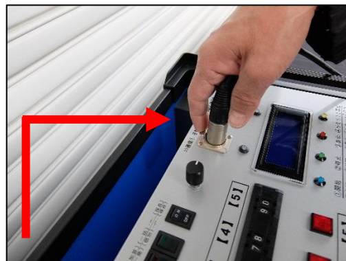
<操作卓 通信ケーブルを外す> 金具ピンを押しながらプラグを抜く
