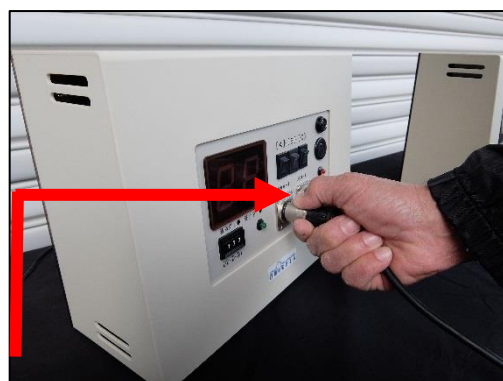
<子機 通信ケーブルを外す> 子機側のツメを押し込み抜いてください
