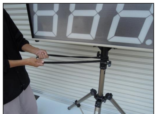
⑫ゴム紐等を利用して固定物へため転倒防止に務める
