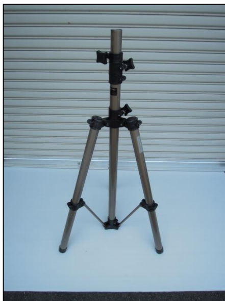
<広げた脚が狭いため不安定な状態>
