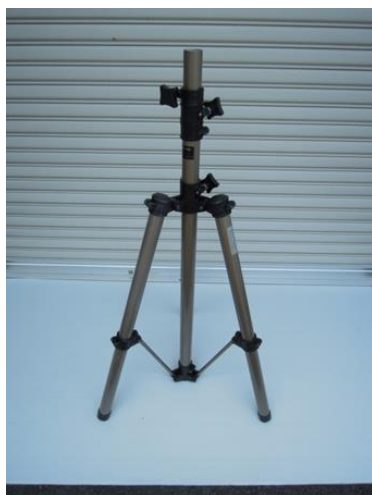
<広げた脚が狭いため不安定な状態>
