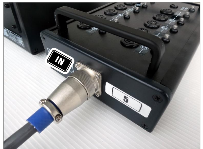
[IN] 側へ接続、ネジをしっかり締める
