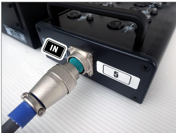
[IN] 側へ接続、コネクタの溝を合わせる
