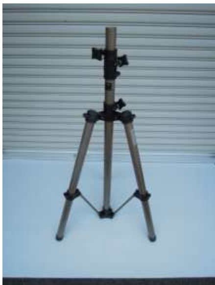
<広げた脚が狭いため不安定な状態>
