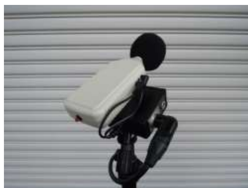
<騒音計マイクユニットへ4Pin ケーブルを接続>
