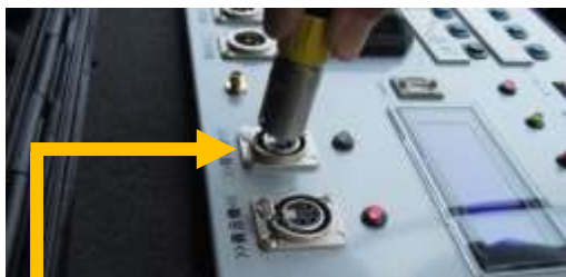
＜通信ケーブルの接続＞ カチッと音がするまで差し込む
