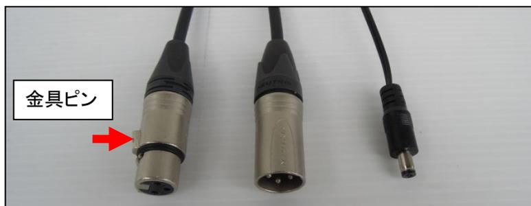
＜通信 3Pin ケーブル＞ ＜電源 (AC アダプタ) ＞
