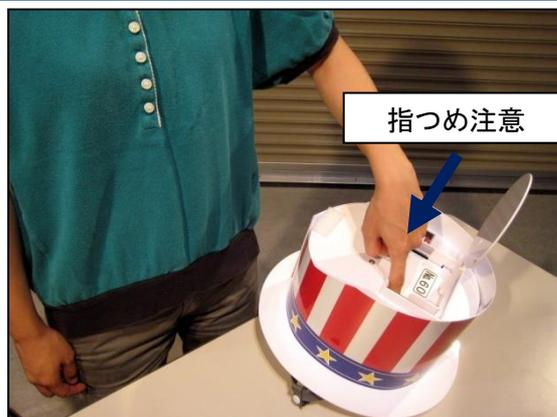
起き上がった札は卓からの操作で自動的に元の位置へ戻りますので手で戻さないでください。札に力が加わると外れるように設計しています。
