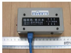
本体 横幅：430mm 高さ：230mm 奥行き：75mm（突起物を除く） 重量：4kg
