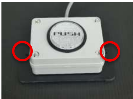
5.5mm の穴が 2 か所 ネジ-ネジ間は 60mm
